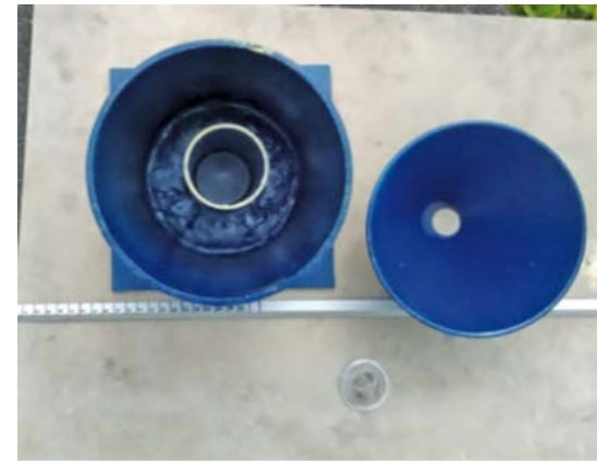
Fotografía 6. Detalles del pluviómetro en proceso de ensamblaje
