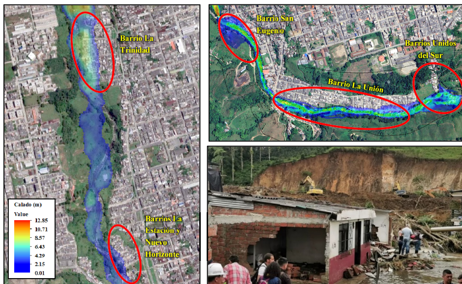
Figura 8. Zonas bajo amenaza de inundaciones del río San Eugenio (Tr = 500 años) Fuente: elaboración propia y RCN, 2022
