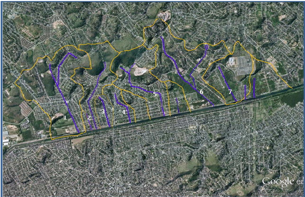
**Figura 9:** Polder Jardim Gláucia/Redentor em detalhe, com indicação dos valões existentes.
