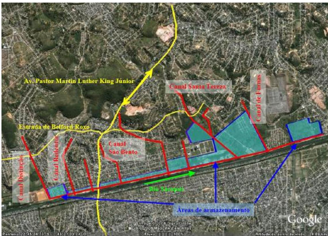
Figura 2: Polder Jardim Gláucia/Redentor em detalhe, com indicação dos valões existentes.
