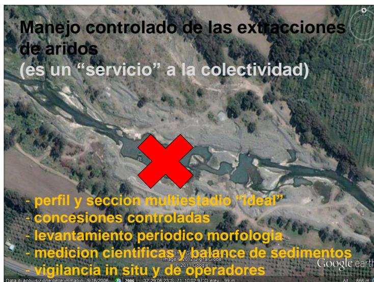
Ejemplo de río “masacrado” por extracciones de áridos sin criterio ni control (agujeros profundos en pleno cauce, abandonados) y proposición de criterios y mecanismos para el manejo de las extracciones de áridos que a la vez pueden servir como medida de control del cauce.
