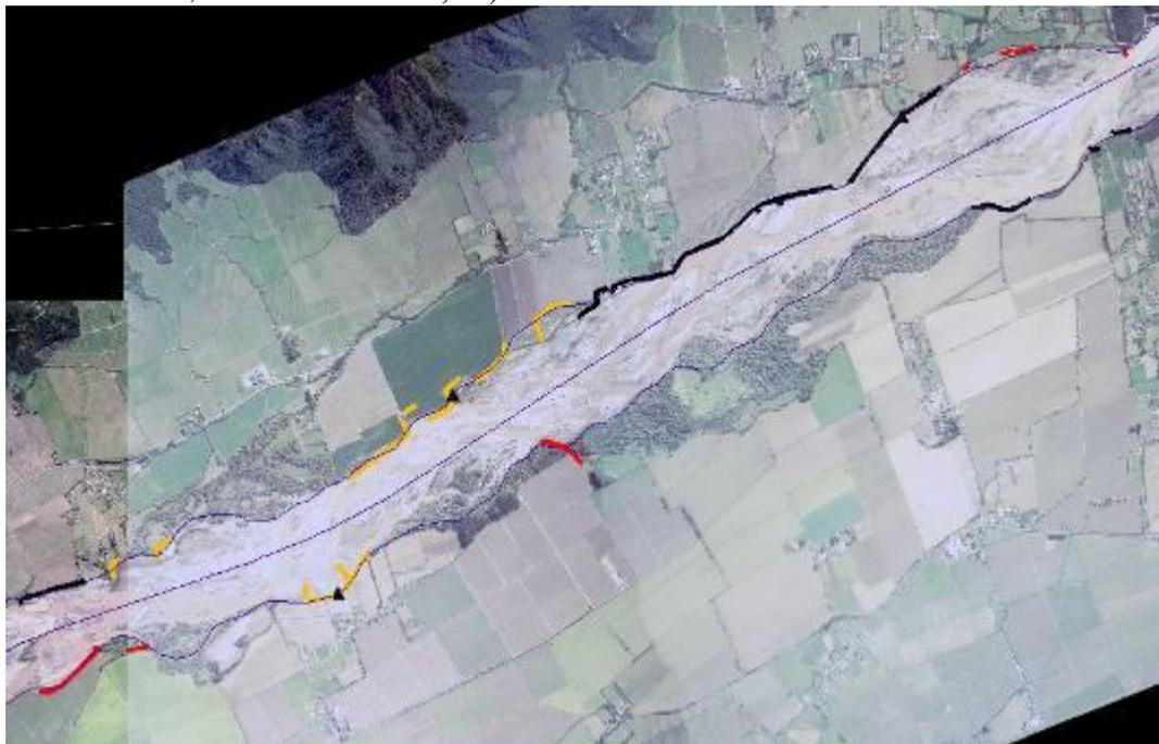
**Ilustración 2:** defensas de ribera existentes en un tramo del río Tinguiririca. En negro los muro de enrocados, en rojo los gaviones, en amarillo los espigones. (Los triangulitos negros indican propuestas de re-construcción de obras de defensa.)
