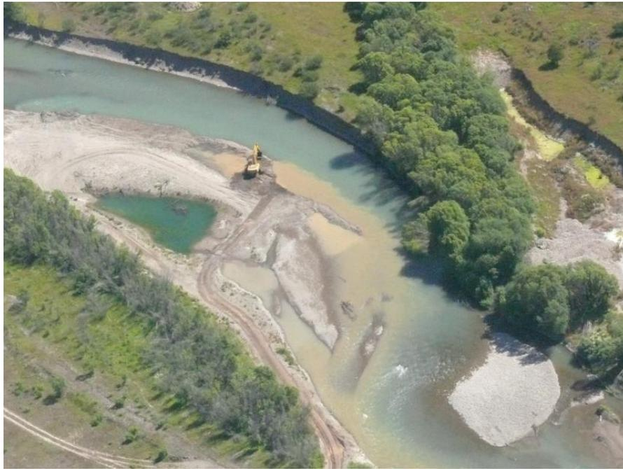
Incremento de la turbidez del agua debido a la extracción de áridos en el río Simpson, aguas arriba de Coyhaique
