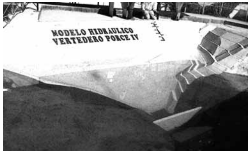
■ Modelo Hidráulico del Vertedero de Porce IV. Presa y taludes preconformados. Fuente: UN-Sede Manizales
