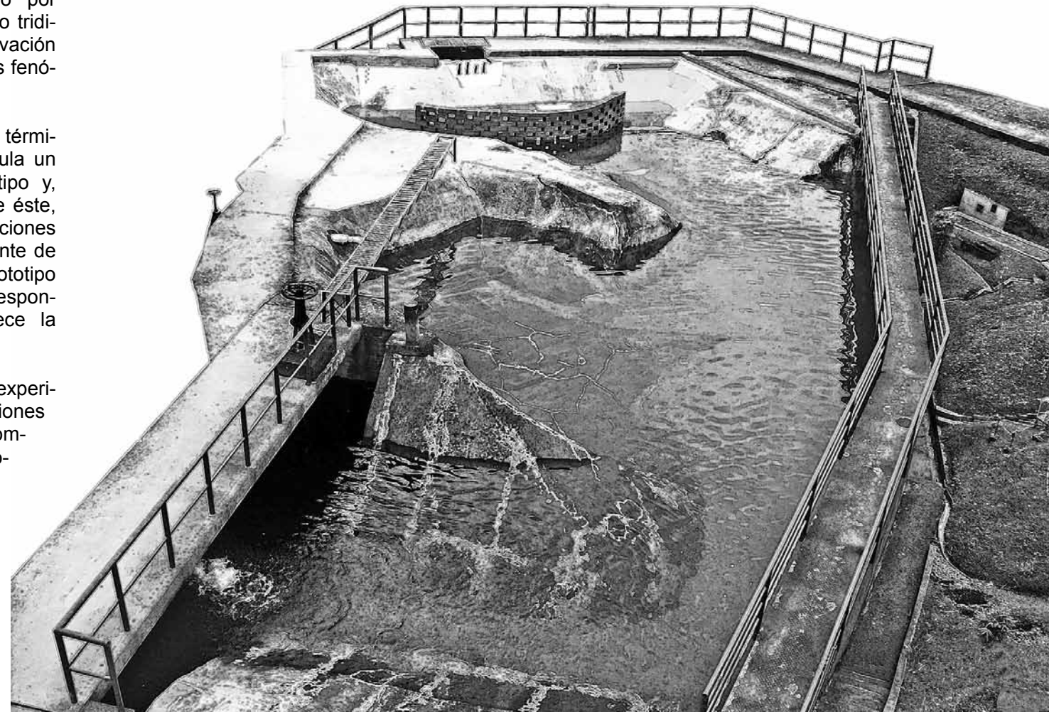
■ Panorámica Zona de Embalse Laboratorio de Hidráulica "Jorge Ramírez Giraldo". Modelo Hidráulico del Vertedero del Quimbo. Fuente: UN-Sede Manizales
