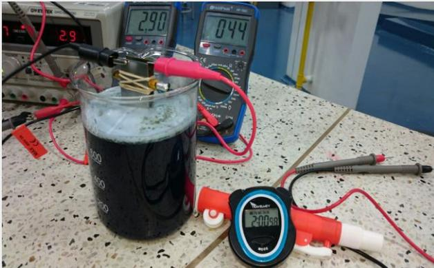
Imagen N.º 5. Iniciando prueba de electrocoagulación con electrodos de 30 cm<sup>2</sup> Fuente: autores
