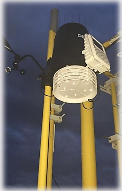
**Fase 3** Instalación de estación meteorológica para la medición de variables climáticas.
