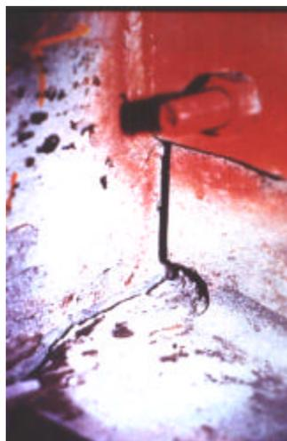
a) Pandeo de columna en pórticos arriostrados    b) Falla de soldadura en pórticos no arriostrados
