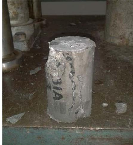
Imagen Nº 11. Fallados de cilindros con vidrio
