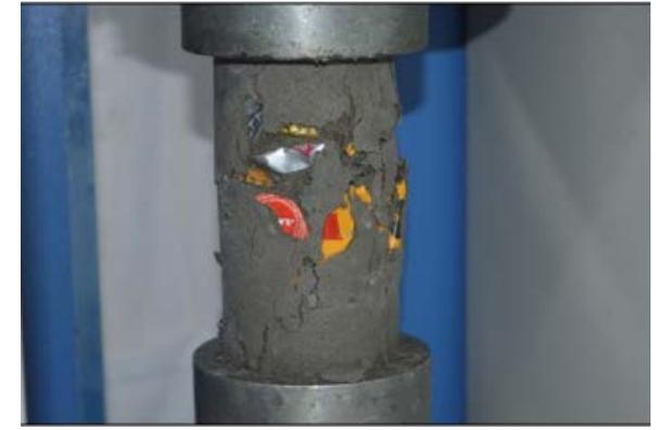
Imagen Nº 10. Fallados de cilindros de concreto
