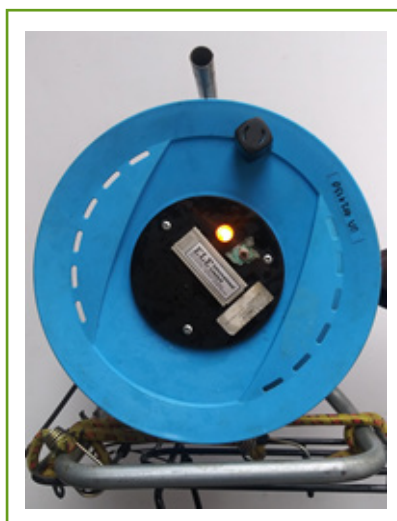
Figura 9. Sonda: suena y alumbra cuando toca el agua. Fuente: propia
