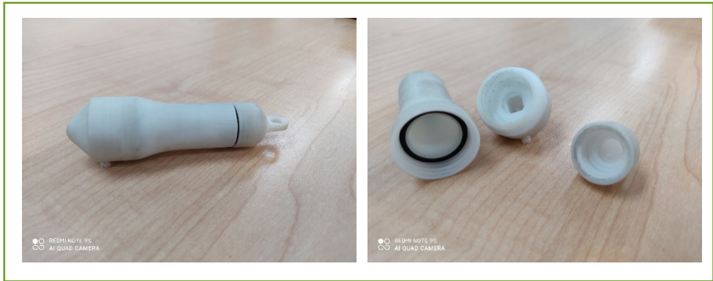
Figura 14. Carcasa en impresión 3D en resina. Fuente: propia
