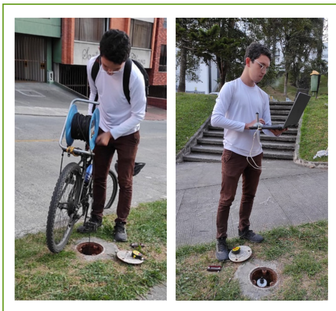
Figura 8. Medición manual del nivel freático (izquierda). Descarga de datos almacenados en los sensores (derecha). Fuente: propia
