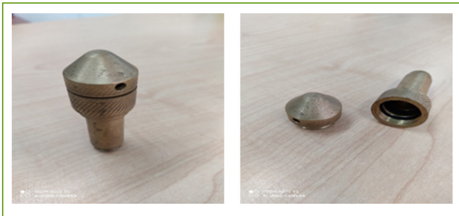
Figura 17. Carcasa en bronce. Proceso de fabricación mecanizado. Fuente: elaboración propia
