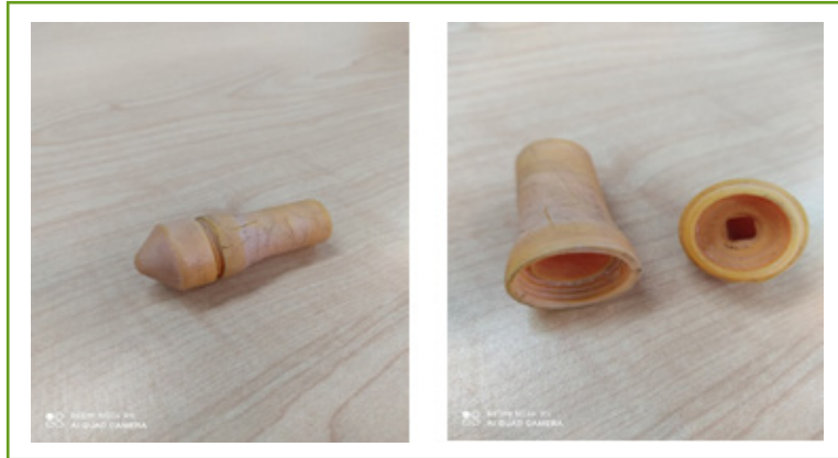
Figura 16. Agrietamiento en la carcasa plástica por la inmersión en el pozo durante varios días Fuente: propia
