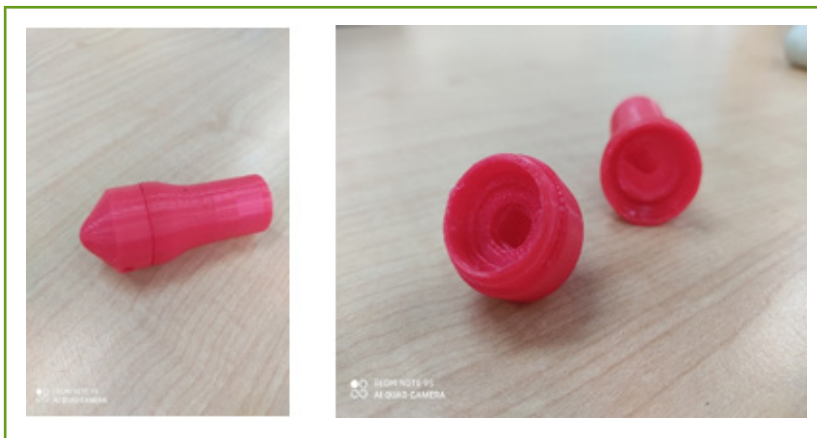
Figura 15. Impresión 3D en material PLA. Fuente: propia
