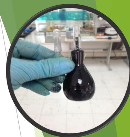
Se realizaron las pruebas de calidad a la pintura terminada con base en la norma NTC 1335: porcentaje en volumen de sólidos, entizamiento, tiempo de secado para repintar, tiempo de secado total, rendimiento y poder de cubrimiento. Se determinó el contenido de cromo VI por espectrofotometría con difenilcarbazida en la viruta disuelta, por ser esta forma de cromo no permisible en pinturas.
